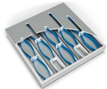
Ein Mikrolautsprecher mit beweglichen Lamellen (blau). Aus den schlitzförmigen Öffnungen des Chips gelangt der Schall zum Trommelfell des Nutzers. Foto: Bosch Sensortec
