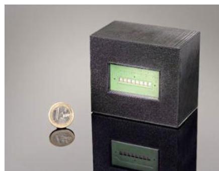
Frontansicht einer Ultraschallkamera mit siliziumbasierten Ultraschallwandlerchips
